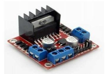
Figure 4.6. L298N Motor Driver IC
